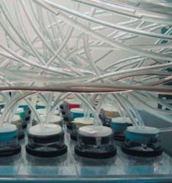
Mit einem Durchflussversuch wurde der Einfluss der Trübstoffe auf die Daphnien analysiert.
